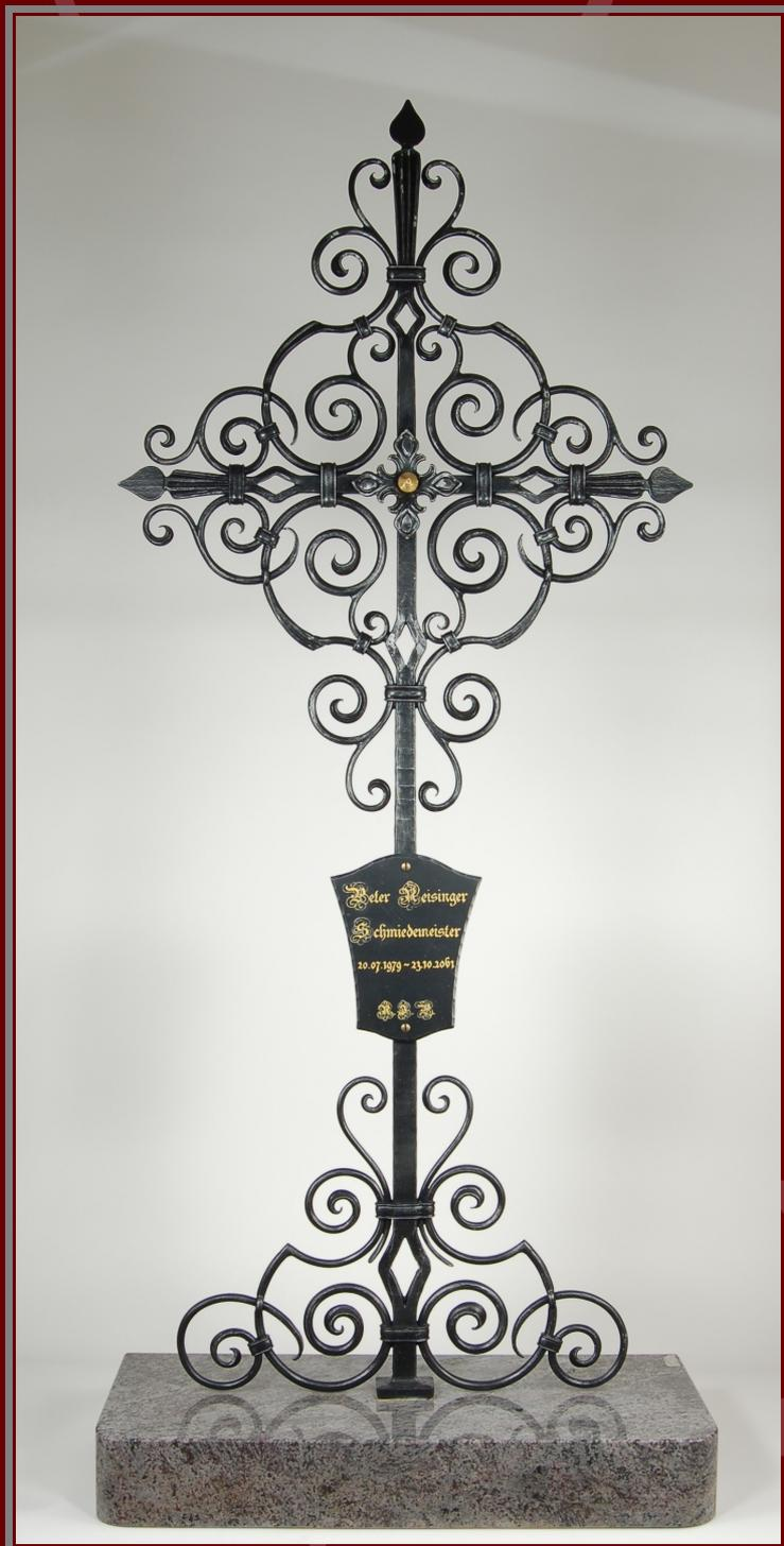
Handgeschmiedetes Grabkreuz in Renaissanceform. Die Ornamentik ist aus Rundmaterial geschmiedet. Die Schnörkelanfänge sind sichelförmig geschmiedet und graviert. Alle Verbindungen sind mit Bündel versehen. Das Eisenkreuz ist verzinkt, grundiert und schwarz matt lackiert. Zur Befestigung am Sockelstein, mittels mitgelieferten Montageschrauben, vorbereitet. Preis gültig ohne Grabtafel. Kreuzstamm tordiert.
